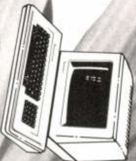
XEROX 820 sous CP/M Micro-processeur 280, mémoire 64 Ko, écran 80 colonnes, claviers numérique et AZERTY accented, disquettes 92 ou 300 Ko.
